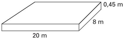
$$V_{\text{Rest}} = 20 \text{ m} \cdot 8 \text{ m} \cdot 0,45 \text{ m}$$
