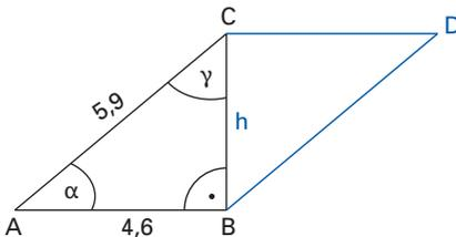
Berechnung der Höhe h des Parallelogramms mithilfe des Satzes von Pythagoras:
